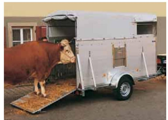
**VR 1801** in Aluminium-Ausführung mit 1250 mm hohen Seitenwänden. **Zubehör:** Regelbarer Lüftungsschieber (450 x 300 mm) in Seitenwand, Dachgestell und Plane 600 mm hoch.
