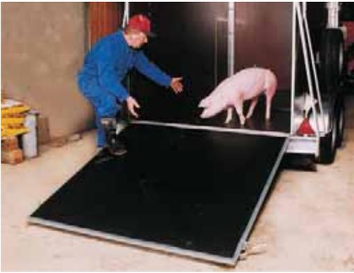
Streßfreie Verladung und Transport durch **Verschleißbelag** (Zubehör) aus 8 mm Noppen-Gummimatte. Im Laderaum seitlich mit Kantenversiegelung, auf der Heckklappe ohne Latten.
