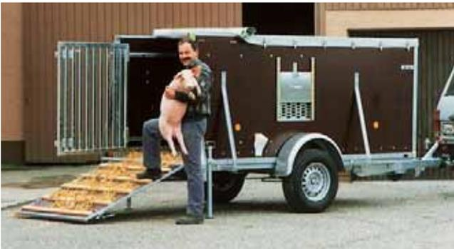
**VR 1801** in Multiplex-Ausführung mit 1250 mm hohen Seitenwänden. **Zubehör:** Regelbarer Lüftungsschieber (450 x 300 mm) in Seitenwand, Flachplane, Trenngitter mit Verstellschienen, Rohrstützen.
