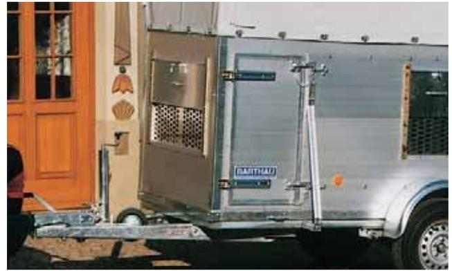
**Zubehör: Lüftungsschieber** aus Aluminium-Blech. Die Luftzufuhr wird durch das Heben und Senken des Außenbleches reguliert. Die **Schlupftüre** auf der linken Seite (Fahrerseite) ist **serienmäßig**. Sie ist zugfrei und von innen durch Tiere nicht zu öffnen.
