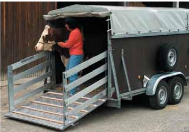
**Zubehör: Laufgatter** aus Aluminium auf Heckklappe schwenkbar. Beide Laufgatter werden während des Transports hinten quer aufgestellt. **Verschleiß- und Schutzbelag** aus Alu-Riffelblech im Laderaum und auf Heckklappe, mit Holzplatten.
