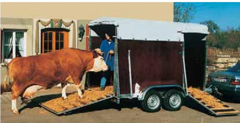
**VR 2002** in Multiplex-Ausführung mit 1500 mm hohen Seitenwänden und Entladeklappe vorne. Die 1500 mm hohe Heckklappe ermöglicht ein müheloses Begehen des Anhängers. Die zusätzlich angebrachten Latten verhindern ein Abrutschen der Tiere.
