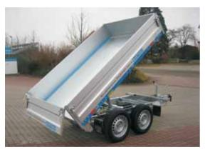
**Typ DK** hintere Klappe serienmäßig mit Pendelbordwand und mit Zentralverriegelung der Scharniere von der Seite mittels Totpunkthebel. Mit **Zubehör:** Verschleiß- und Schutzbelag aus 1,5 mm verzinktem Stahlblech auf dem Boden.
