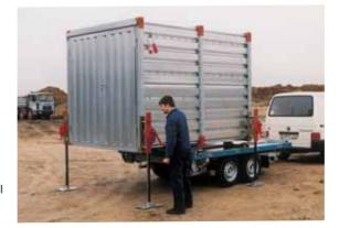
**DK 3502** mit **Zubehör:** Transportwechselsystem (Container), absetzbar per Stapler oder Kran oder auf Wunsch mit Hebesystem (4 Hubwinden mit breiten Auflagen für Einsatz in unbefestigtem Gelände). Der Container muß mit Kantholz unterlegt werden. Das Hebesystem muß lose mitgeführt werden, weil für eine Staubox kein Platz ist. Beschreibung von Transportwechselsystem im Prospekt Nr. 7.
