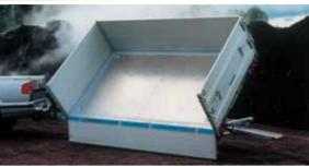
**DG 2702 serienmäßig:** u. a. mit Alu-Auffahrrampen unter der Ladefläche in Halterungen einschiebbar; 2 Klappstützen hinten; heckseitige **Pendelbordwand mit Zentralverriegelung. Zubehör:** Aluminium-Aufsätze, 25 mm dick, 400 mm hoch, werkzeuglos steckbar, heckseitig pendelbar, Verschleiß- und Schutzbelag aus 4 mm Alu-Riffelblech auf der Multiplex-Bodenplatte, 4 Stück im Boden versenkte Anbinderinge.
