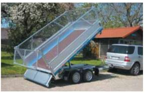
**DK 2702** mit **Zubehör**: Gitteraufsätze, feuerverzinkt, 600 mm hoch, werkzeuglos steckbar, 3seitig pendelbar. Optimale Laderaumausnutzung beim Transport von leichtem Ladegut wie Grasschnitt, Laub usw.
