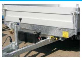
Zubehör Zusatzbatterie: Die elektrische Hydraulikpumpe wird zusätzlich verstärkt mit einer Batterie, die in einer Kunststoffbox am Anhänger platziert ist. Diese Batterie wird durch das dicke Anschlusskabel während des Fahrbetriebes ständig aufgeladen. Durch die beiden Batterien (vom Anhänger und vom Zugfahrzeug) ist eine stärkere Belastung möglich.
