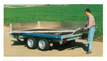
**DK 2702** mit **Zubehör:** Verschleiß- und Schutzbelag aus 4 mm Alu-Riffelblech auf den Bordwandinnenseiten. Die Bordwände sind serienmäßig 4seitig abklappbar und werkzeuglos abnehmbar, die Eckrungen sind gesteckt/ abnehmbar (Umrüstbar für Transportwechselsystem!).
