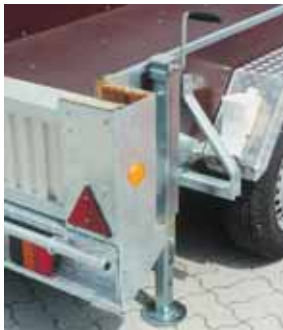
Geräuschdämmung an der Rampenhalterung durch serienmäßig montierte Kokosmatte (nur bei GTA). Teleskopstütze , mit Sperrbolzen arretierbar, Feineinstellung über Handkurbel, Tragkraft 1500 kg/Stk.
