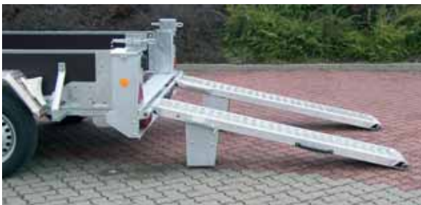
Zwangsabstützung für Aluminium-Auffahrampen (nur bei GTB). Keine Kurbelstützen mehr erforderlich. Schnellere Bedienung und Fahrbereitschaft. Das Stützenanheben kann nicht mehr vergessen werden.
