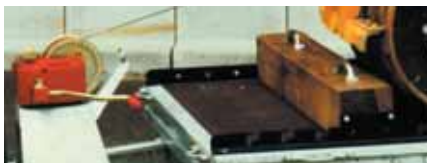
Ladungssicherung speziell für Walzen durch zwei in der Länge verstellbare Querbalken. Diese werden in Arretierschienen rechts und links an der Seitenwand verzapft.
