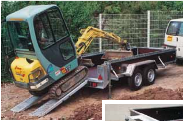
GTA 3502 in Länge 4050 mm: serienmäßig mit Gurtleiste als zusätzliche Stabilitätsreserve. Zubehör: Baggerlöffelablage , an der Stirnwand montiert.
