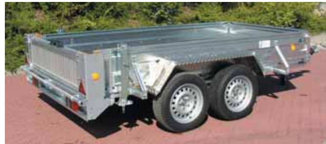
GTA 2702 mit Stahlblech-Bordwänden 400 mm hoch. Serienmäßig Aluminium - Auffahrampen hinten zum Transport quer eingesteckt. Zwei stabile Vierkantstützen mit Fallhub und Feineinstellung durch Kurbel, Tragkraft 1500kg/Stück.
