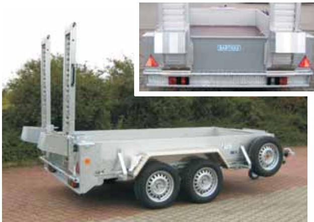
GTB 2702 mit Aluminium-Bordwänden 400 mm hoch. Serienmäßig Einsteckteil aus Stahlblech zwischen den Rampen und Zwangsabstützung der Aluminium-Auffahrampen.
