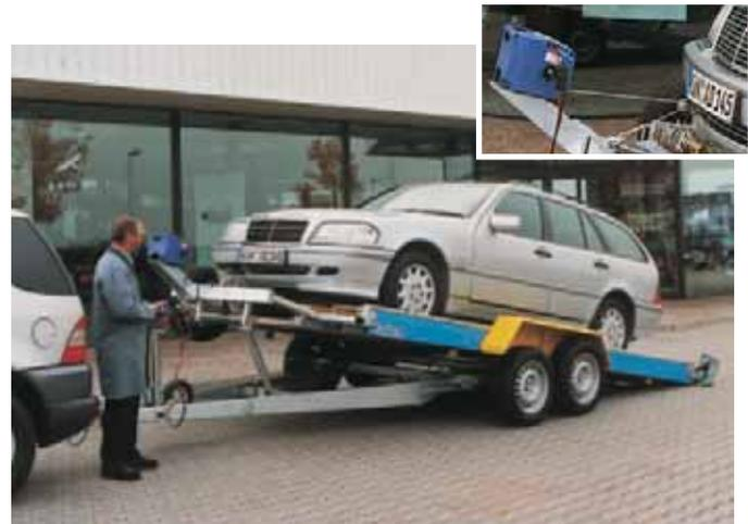
**AT 2702** überzeugt durch große freie Deichsellänge und extrem flachen Auffahrwinkel. **Zubehör: elektrische Seilwinde** mit Fernbedienung (1000 oder 1500 kg Zugkraft) an stufenlos verstellbarem Windenbock. Anschluß 12 oder 24 Volt möglich.
