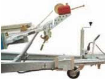
**Zentralverriegelung** zur Sicherung der Kippeinrichtung, wird nur auf rechter Seite bedient. **Stützrad schwer**, automatisch umklappbar. Zweistufiger **Teleskopzylinder**. Zubehör: **Seilwinde**.
