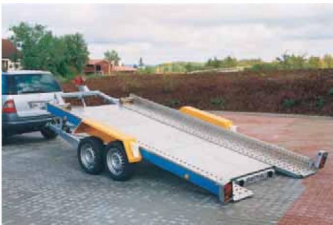
**AT 3502** serienmäßig in **blau-gelbem Design** und mit **2 Verstellkeilen** zur Ladungssicherung. Zubehör: 3-teiliger **Alu-Riffelblech-Zwischenboden**. Seilwinde, 900 kg Zugkraft, Windenbock verstellbar.
