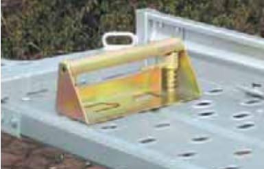
Verstellkeile zum Anfahren für PKW, über die gesamte Anhängerlänge verstellbar. 8 Stück TOPZURR22 Zurrösen, beweglich und verstellbar über die gesamte Anhängerlänge.
