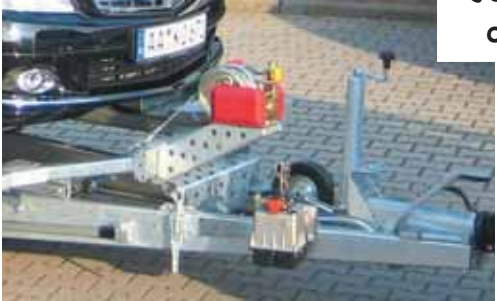
Excenterverschluß mit Sicherungsklinke zur Sicherung der Kippeinrichtung. Stützrad schwer , automatisch umklappbar. Zweistufiger Teleskopzylinder . Zubehör: Seitlich verschiebbarer Windenbock und mechanische Seilwinde mit Abrollautomatik (kein Rückwärtskurbeln).
