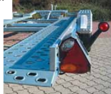
Beleuchtung geschützt seitlich montiert. Flache Auffahrkante . Griffige Stanzlochungen , besonders rutschfest! Begrenzungsleuchten mit flexiblem Anbauarm (Gummiarm).
