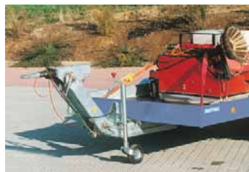
Zubehör: Höhenverstellbare Auflaufbremse, mit DIN-Zugöse, verstellbar von 400 bis 1100 mm Anhänghöhe.
