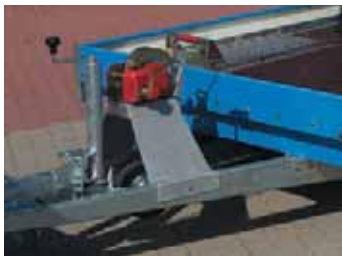
Zubehör: Seilwinde mit Windenbock und Verstellkeil auf Aluminium-Arretierblech.
