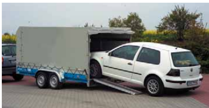
MZ 2702 mit Zubehör: Aluminium-Auffahrrampen, Bordwände Aluminium 200 mm hoch, Dachgestell und PVC-Plane, Ladehöhe 1600 mm, windschnittig vorne abgeschrägt für niedrigen c_w -Wert, Heckklappe aus Aluminium.
