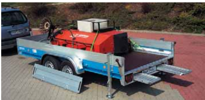
MZ 3502 mit Zubehör: Aluminium-Auffahrrampen, Teleskopstützen, Heckklappe und Aluminium-Bordwände, 200 mm hoch (Gesamthöhe 350 mm).
