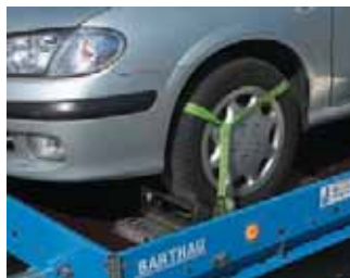
Zubehör: Verstellkeil auf Aluminium-Arretierblech.
