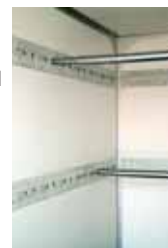
Zubehör Zurrstreifen Barthau TOPZURR24 Genauso wie im Rahmenprofil können in der Barthau Zurrstreifen die Nockenfitting auf die ganze Länge und vorne montiert werden. Zusätzlich können auch Absperrstangen rund verzinkt auf die ganze Länge und auf 2 Höhen eingesetzt werden. Diese optimale Ladungssicherung ist für jede Ladung nutzbar und unentbehrlich.
