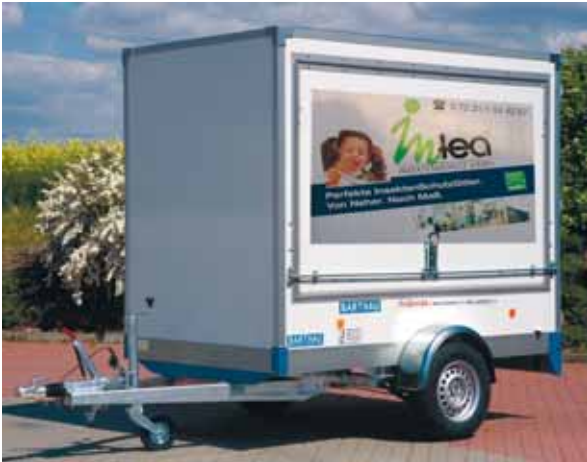
CT 1801 mit Sonderwunsch: Verkaufsklappe links mit großen stabilen Gasfedern und Feststeller, Brüstung 500mm hoch. Serienmäßig von innen verriegelt oder gegen Mehrpreis mit Drehstangenverschuß von außen abschliessbar.
