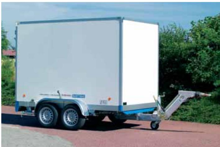
**CT 2702** mit Zubehör **Verstellbremse**: Problemloses Wechseln zwischen verschiedenen Zugfahrzeugen durch höhenverstellbare Auflaufbremse mit LKW-DIN-Zugöse, **verstellbar von 400 bis 1100 mm Anhängöhe**. Auf Wunsch mit Kugelkupplung zum Wechseln.
