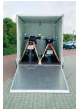
**CT 2702** Sonderwunsch: Mit Laderampe, belegt mit Aluminiumriffelblech, rutschfest, kein Spalt zwischen Rampe und Anhängerboden. Zusätzlich mit Motorradstandschiene zum Transport von Motorrädern. In der Mitte wurde zusätzlich ein Zurrprofil für die Zurrgurtaufhängung **TOPZURR24** montiert.
