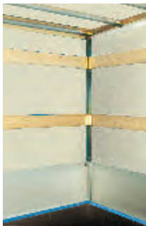
Einschiebbares Dachgestell und PVC-Plane als Zubehör. Linke und rechte Abbildung: ausgezogen auf 2100 mm Ladehöhe. Mittlere Abbildung: eingeschoben auf 1600 mm Ladehöhe. Es werden alle 4 Eckpfosten oben eingeschoben, deshalb ist nicht die ganze Last des Daches zu bewegen. Die Plane hat 2 Reihen Befestigungsösen rundum. Bei eingeschobenem Dachgestell wird der untere Teil der Plane nach innen hochgeklappt und mit Klettverschluss befestigt (Kasackausführung). Die Plane wird dann mit den oberen Ösen montiert.
