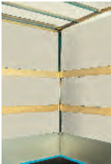
Einschiebbares Dachgestell und PVC-Plane als Zubehör. Linke und rechte Abbildung: ausgezogen auf 2100 mm Ladehöhe. Mittlere Abbildung: eingeschoben auf 1600 mm Ladehöhe. Es werden alle 4 Eckpfosten oben eingeschoben, deshalb ist nicht die ganze Last des Daches zu bewegen. Die Plane hat 2 Reihen Befestigungsösen rundum. Bei eingeschobenem Dachgestell wird der untere Teil der Plane nach innen hochgeklappt und mit Klettverschluss befestigt (Kasackausführung). Die Plane wird dann mit den oberen Ösen montiert.
