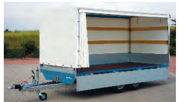
SP Zubehör PVC-Plane und Dachgestell aus verzinktem Vierkantrrohr geschraubt mit 100mm Steigung. Besonders zu empfehlen ist, wenn das Dachgestell und die Plane als Schiebeplane ausgerüstet werden. Die Schiebeplane mit Leichtlaufrollen aus Polyamid läßt sich spielend leicht nach vorne ziehen, der Anhänger ist schneller offen. Bei normaler Plane lässt sich eine große Plane nur schwer nach oben werfen und der Wind weht sie leicht wieder herunter. Jede Höhe für Anhänger lieferbar, jedoch nicht mit einschiebbarer Plane (Kasackplane) und nicht mit Zollverschluss.
