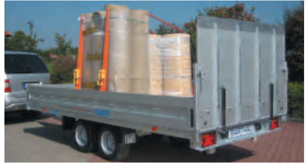
TK 3502 serienmäßig mit hydraulisch kippbarer Ladefläche, flacher Auffahrwinkel durch hohe, überfahrbare Heckklappe, mit Aluminium-Riffelblech belegt, mit Gasfeder als Rampenheber. Hintere lange Eckkrune gesteckt.
