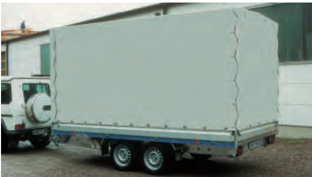
SP Zubehör PVC-Plane und Dachgestell aus verzinktem Vierkantrrohr geschraubt mit 100mm Steigung. Besonders zu empfehlen ist, wenn das Dachgestell und die Plane als Schiebeplane ausgerüstet werden. Die Schiebeplane mit Leichtlaufrollen aus Polyamid läßt sich spielend leicht nach vorne ziehen, der Anhänger ist schneller offen. Bei normaler Plane lässt sich eine große Plane nur schwer nach oben werfen und der Wind weht sie leicht wieder herunter. Jede Höhe für Anhänger lieferbar, jedoch nicht mit einschiebbarer Plane (Kasackplane) und nicht mit Zollverschluss.
