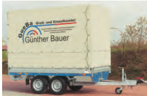
Einschiebbares Dachgestell und PVC-Plane als Zubehör. Linke und rechte Abbildung: ausgezogen auf 2100 mm Ladehöhe. Mittlere Abbildung: eingeschoben auf 1600 mm Ladehöhe. Es werden alle 4 Eckpfosten oben eingeschoben, deshalb ist nicht die ganze Last des Daches zu bewegen. Die Plane hat 2 Reihen Befestigungsösen rundum. Bei eingeschobenem Dachgestell wird der untere Teil der Plane nach innen hochgeklappt und mit Klettverschluss befestigt (Kasackausführung). Die Plane wird dann mit den oberen Ösen montiert.
