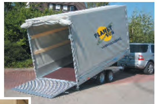
SP Zubehör PVC-Plane und Dachgestell aus verzinktem Vierkantrrohr geschraubt mit 100mm Steigung. Besonders zu empfehlen ist, wenn das Dachgestell und die Plane als Schiebeplane ausgerüstet werden. Die Schiebeplane mit Leichtlaufrollen aus Polyamid läßt sich spielend leicht nach vorne ziehen, der Anhänger ist schneller offen. Bei normaler Plane lässt sich eine große Plane nur schwer nach oben werfen und der Wind weht sie leicht wieder herunter. Jede Höhe für Anhänger lieferbar, jedoch nicht mit einschiebbarer Plane (Kasackplane) und nicht mit Zollverschluss.
