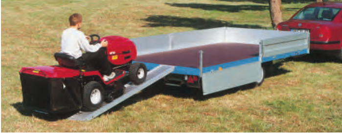
TP 3502 serienmäßig: Mit patentierter Außenrahmenladungssicherung TOPZURR21 rundherum. Eloxierete Aluminium-Bordwände, ringsum abklappbar und abnehmbar, Eckkrungen steckbar, Ladehöhe 680 mm. Zubehör: Aluminium-Auffahrampen 2500 x 350 mm mit Rampenhalterungen unter dem Anhänger, Klappstützen, Bordwände seitlich in der Mitte mit steckbarer Mittelrune geteilt.
