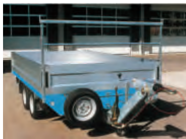
SP mit Bereifung 155/70R12 mit Zubehör: Höhenverstellbare Auflaufbremse mit DIN-Zugöse, wechselbar gegen Kugelumlauf, Ersatzrad vorne montiert wegen Klappstützen hinten, H-Galerie mit Holzeinlage.
