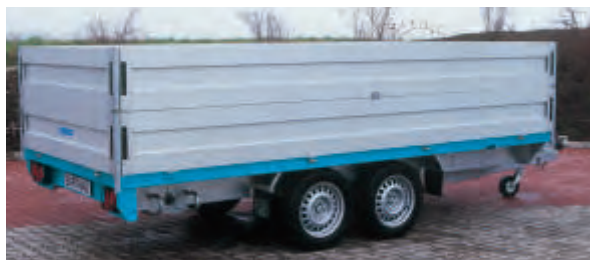
Als Zubehör Aluminium-Aufsätze, 400 mm hoch, werkzeuolos steckbar. Einschiebbare Ersatzradhalterung hinten unter dem Anhänger. Falls am SP Aluminium-Auffahrrampen, Klapp- oder Kurbelstützen montiert werden, kann die einschiebbare Ersatzradhalterung nicht montiert werden. Dann ist nur eine Ersatzradhalterung an der Stirnwand möglich.
