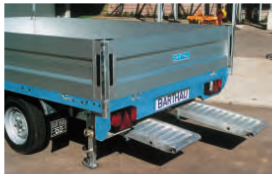
Aluminium-Auffahrrampen, unter der Pritsche eingeschoben mit Klappstützen. (Bei kleinen Rädern 12Zoll nur mit Klappkurbelstützen lieferbar - Mehrpreis).
