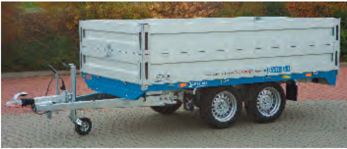
EH 2002 serienmäßig mit hohem Rahmen und 14-Zoll-Bereifung. Aluminium-Bordwände 350 mm hoch, 4seitig abklappbar und werkzeuglos abnehmbar. Zubehör: Aluminium-Aufsatz 350 mm hoch. Bitte beachten: Auf Aufsätze können keine Dachgestelle montiert werden.
