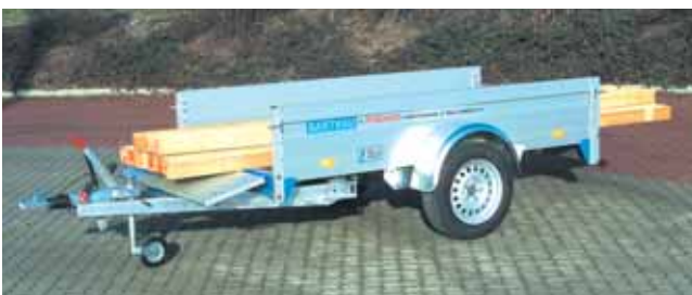
QL 1351 beladen: Vordere und hintere Bordwand abgeklappt.
