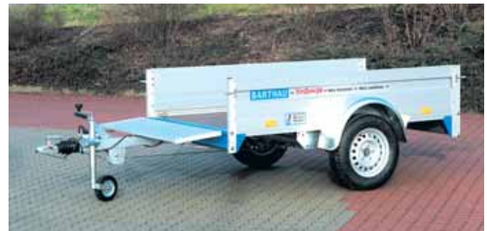
QL 1001 : Vordere und hintere Bordwand abklappbar.
